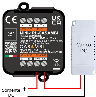
Figura 6: Cablaggio carico DC
